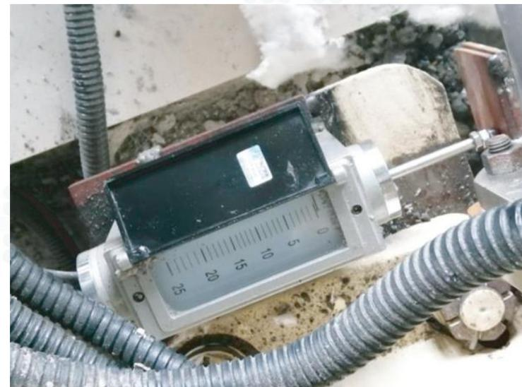
热膨胀用于测量汽轮机
