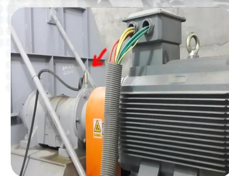
转速传感器按原理分有磁阻式传感器、霍尔传感器、霍尔方向传感器和一体化电涡流传感器。
